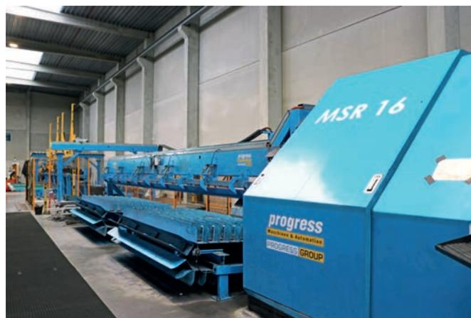
Правильно-гибочный станок Progress MSR 16, интегрированный в линию оборотных поддонов, обрабатывает арматурную сталь с бухты, оптимизируя производственный цикл. Низкие затраты на хранение и упрощенная схема транспортировки материалов существенно повышают экономичность производства
