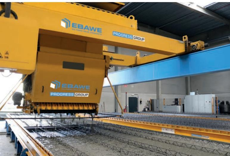
Автоматический бетонораздатчик обеспечивает равномерное и оптимизированное распределение бетонной смеси в опалубке
