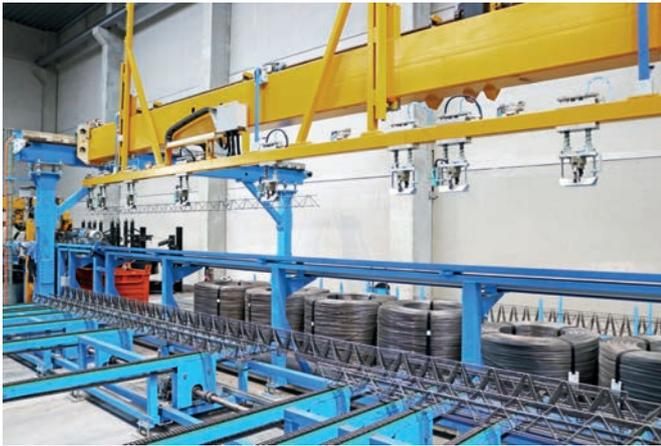
Станки для сварки армокаркасов и манипуляторы Progress серии VGA Versa являются оптимальными решениями для гибкого и своевременного производства решетчатых балок
